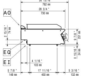
Electrical inlet (power) **Equipotential** screw
